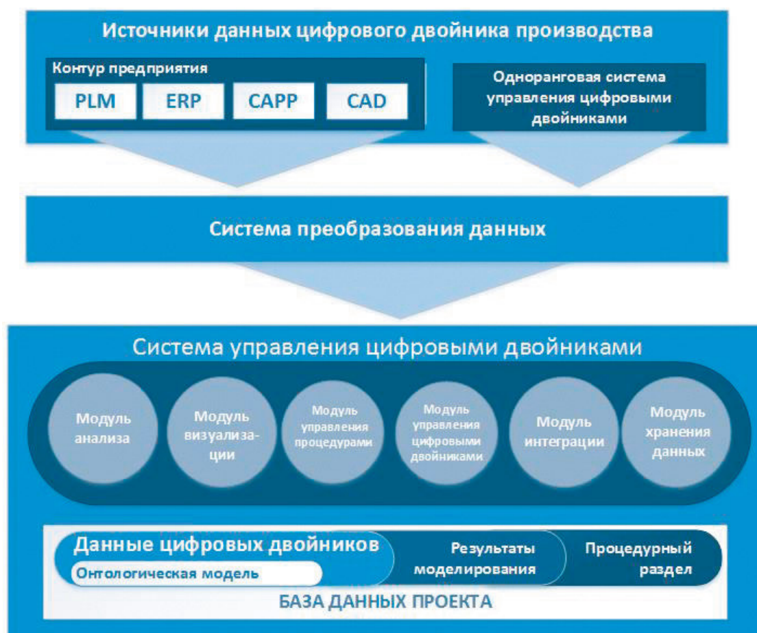
Рис. 1. Программно-аппаратная инфраструктура управления цифровыми двойниками производства. Источник: разработано авторами на основании собственных исследований
