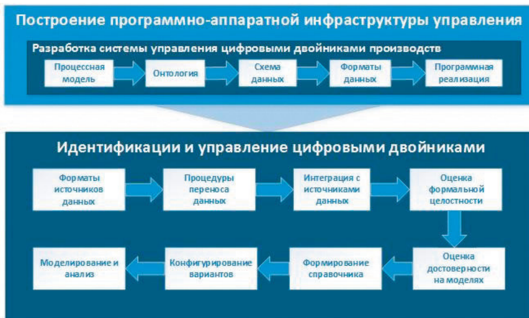
Рис. 2. Два этапа организации параллельной разработки концепций и анализа цифровых двойников производств. Источник: разработано авторами на основании собственных исследований
