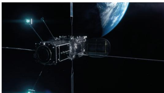
Рис. 2. Аппарат MEV, состыкованный со спутником клиента.
