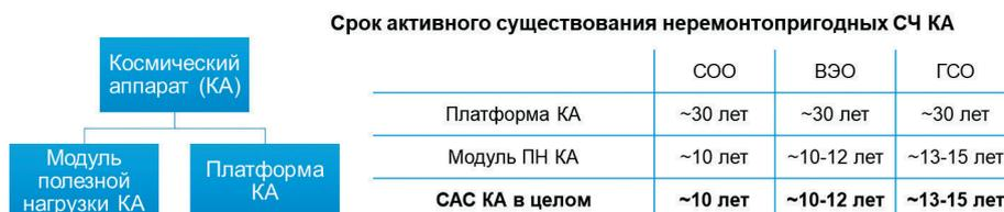
Рис. 4. Устоявшиеся сроки морального устаревания основных СЧ КА, где СОО – средняя околоземная орбита, ВЭО – высокая эллиптическая орбита, ГСО – геостационарная орбита<sup>9</sup>.
