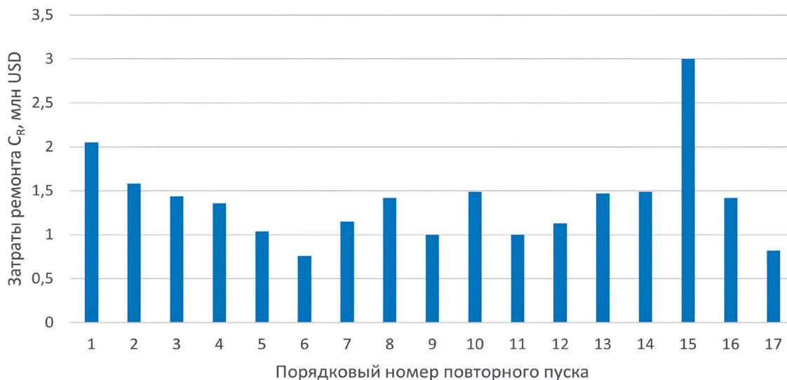
Рис. 5. Предполагаемые затраты на межполетное обслуживание первых ступеней Falcon 9 FT (Block 5), отнесенное к порядковому номеру повторного пуска.
