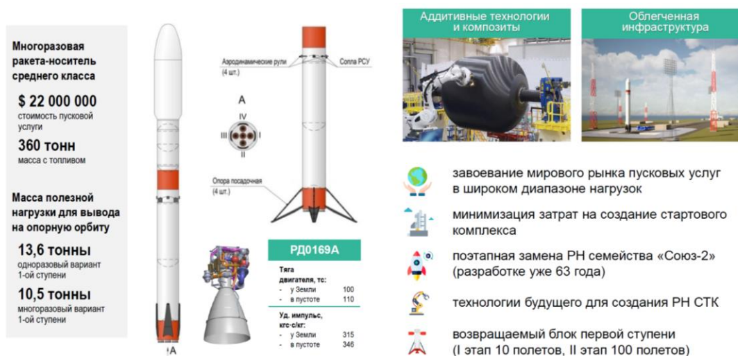
Рис. 2. Проектные характеристики и технологии РН «Амур-СПГ». Источник: Роскосмос [16]
