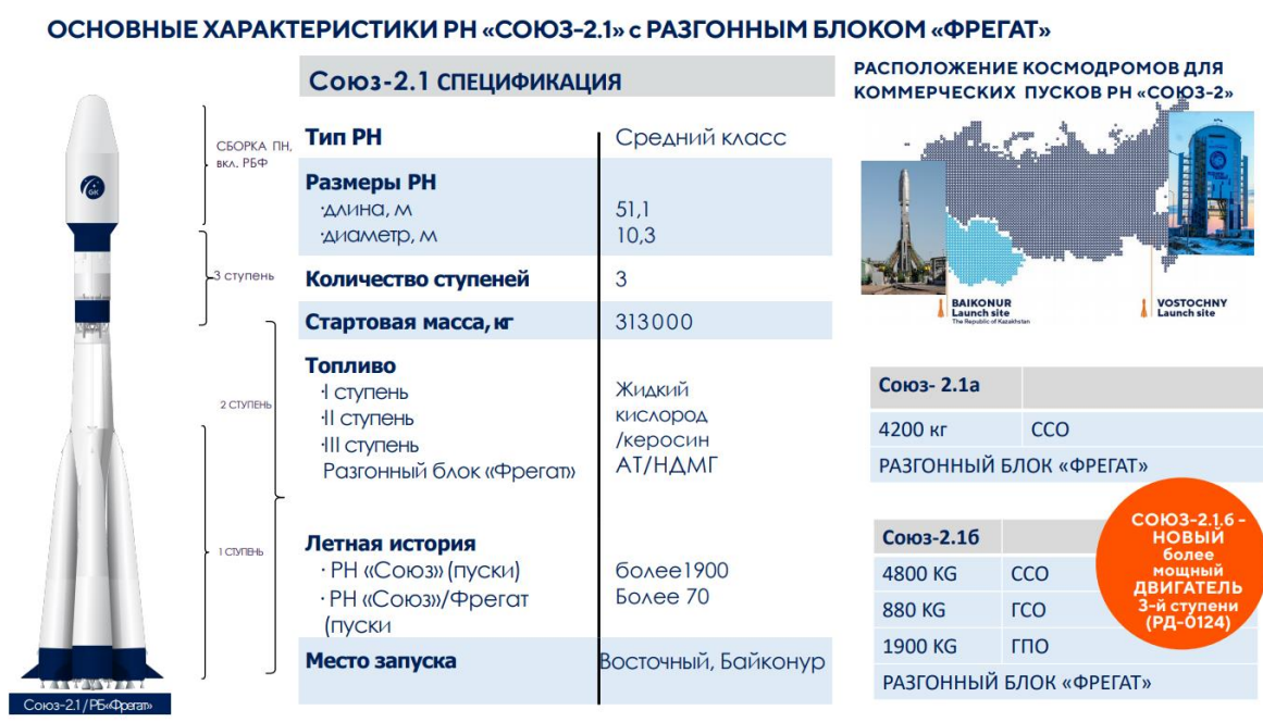
Рис. 8. Основные характеристики РН «Союз-2.1». Источник: Главкосмос Пусковые Услуги [18]
