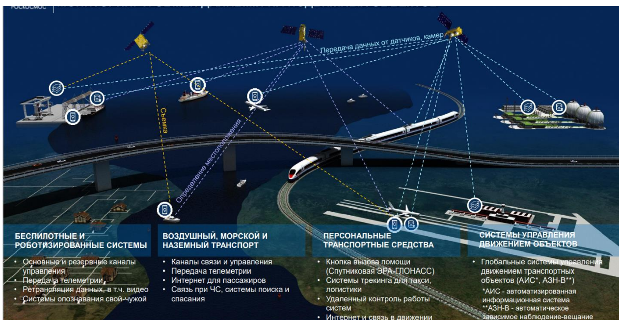
Рис. 13. Сервисы «Сферы» для мониторинга и обмена данными на подвижных объектах. Источник: Роскосмос
