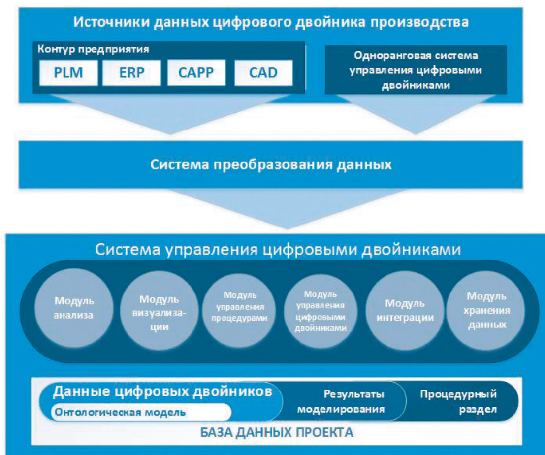
Рис. 1. Программно-аппаратная инфраструктура управления цифровыми двойниками производств. Источник: разработано авторами на основании собственных исследований
