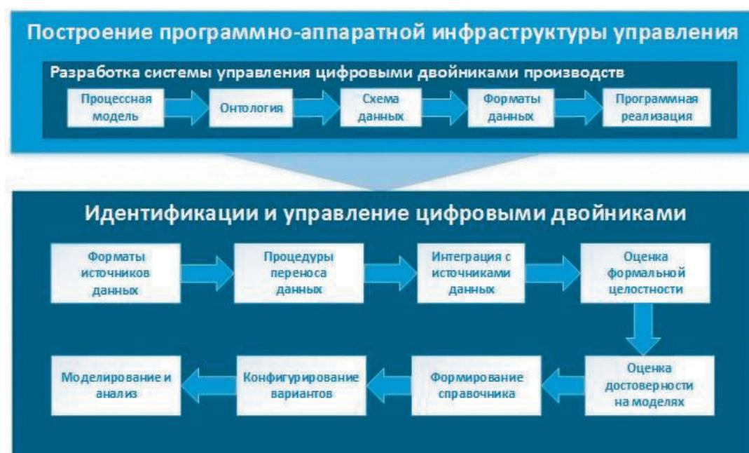
Рис. 2. Два этапа организации параллельной разработки концепций и анализа цифровых двойников производств.
