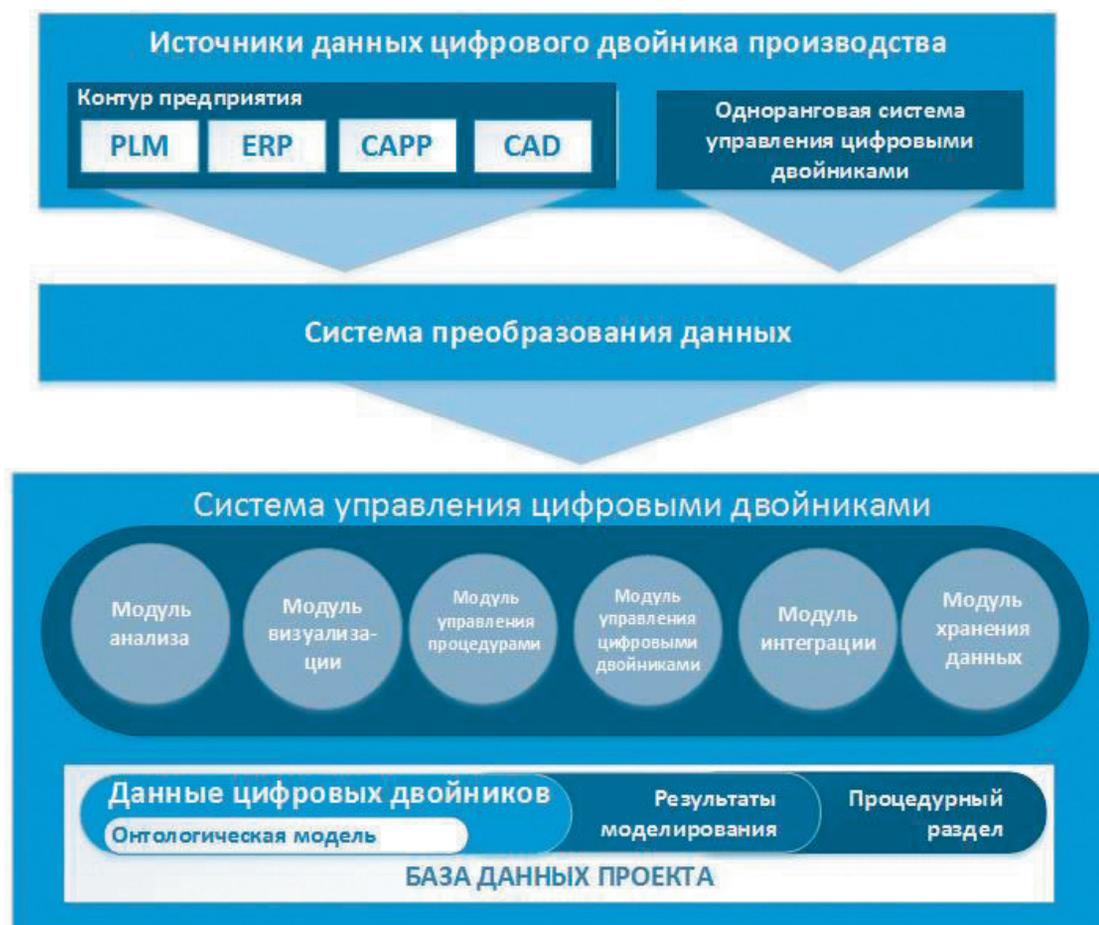
Рис. 1. Программно-аппаратная инфраструктура управления цифровыми двойниками производства.
