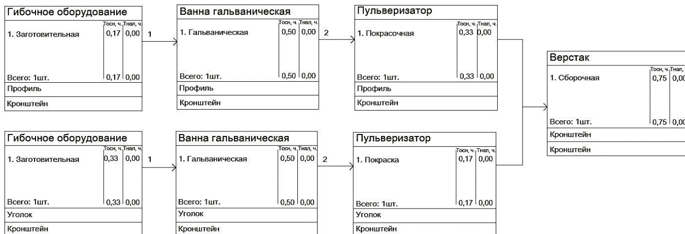
Рис. 3. PERT-диаграммы потока изделия Кронштейн в системе моделирования. В двух нижних строках каждого блока указаны: составной компонент изделия, для которого отображен процесс с данными по операции, и узел/изделие, в который этот компонент входит. Источник: разработано авторами на основании собственных исследований
